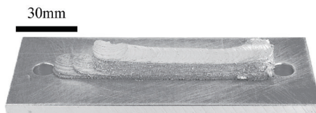
アルミ合金の超高速造形 (5000cm 3 /h)
