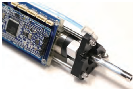
ハイブリッドアクチュエータの先端部分
