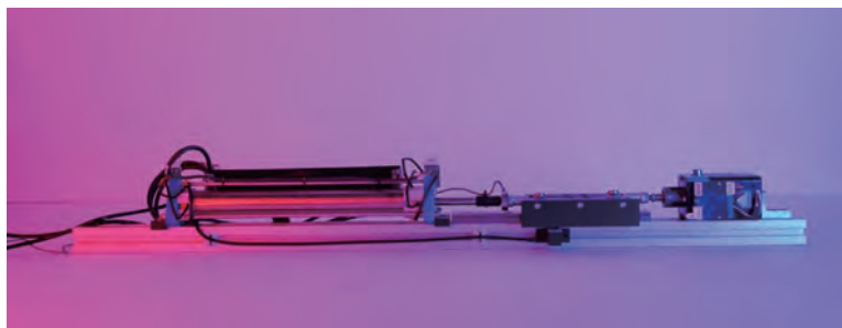
評価装置の付いたハイブリッドアクチュエータ
