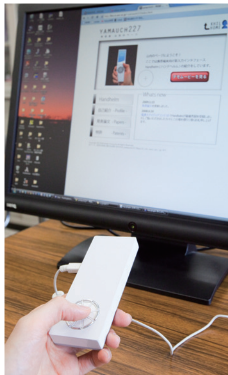
片手入力機器ハンドヘルムの試作機
