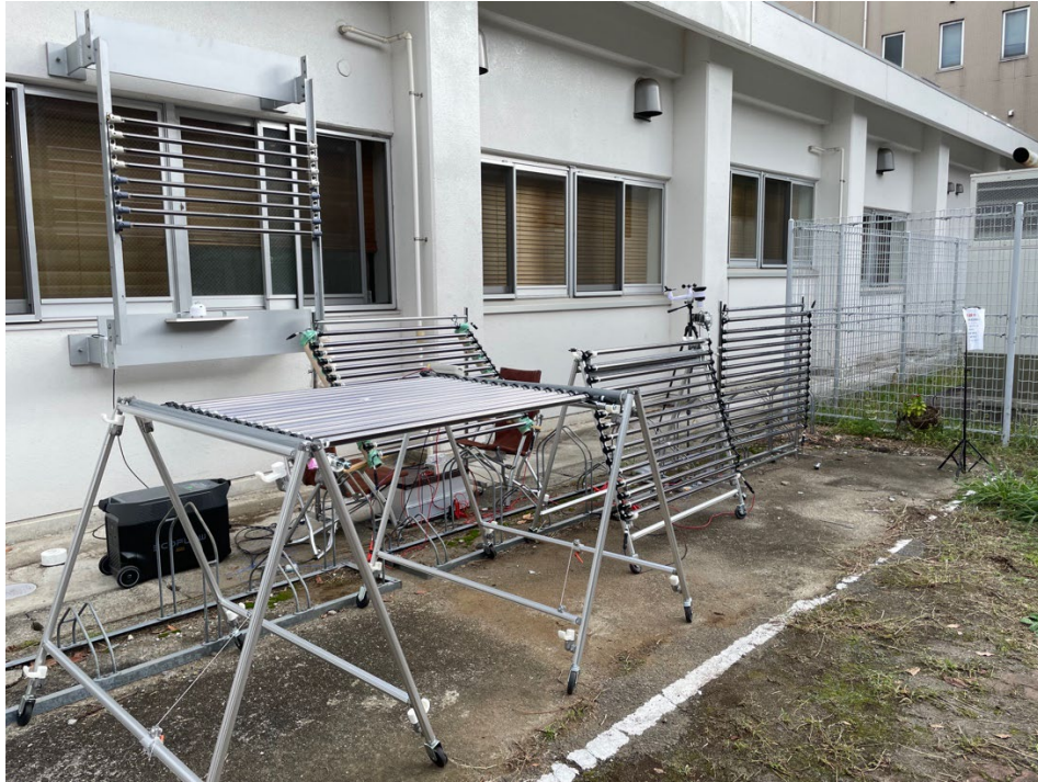
図2. 電気通信大学キャンパス内における円筒形太陽電池の実験例。
