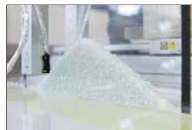
多角形のペレットを漏斗に流す実験
