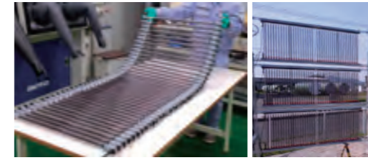
株式会社フジコー、CKD株式会社、ウシオ電機株式会社共同研究成果 開発した円筒形太陽電池モジュール
